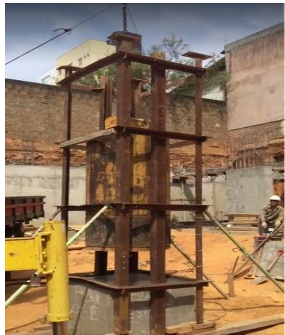
Figura 01 – Dispositivo de aplicação da força de impacto. Martelo em queda livre. Obra da AP&L Geotecnia e Fundações.
