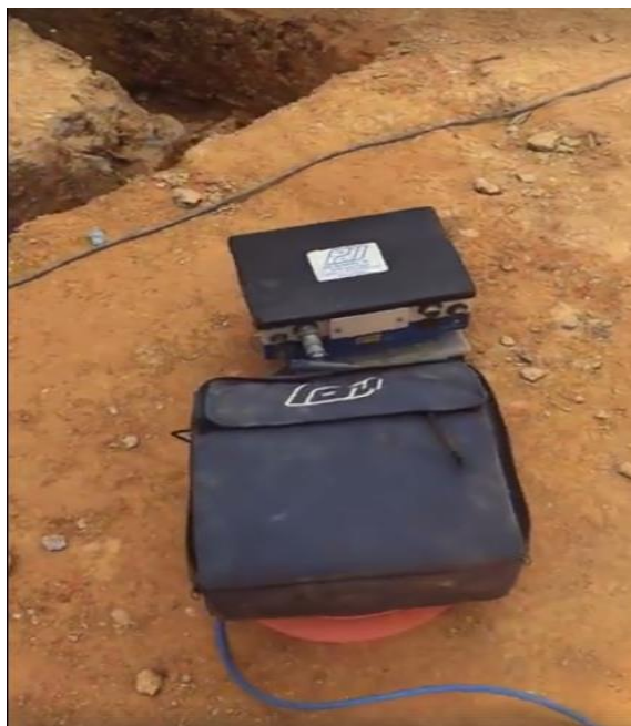
Figura 03- Sinais dos sensores são armazenados no analisador de cravação de estacas (PDA). Obra AP&L Geotecnia e Fundações.
